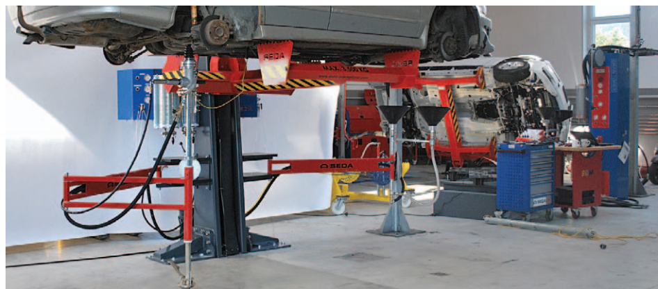
Odsávání s vrtačkou nádrží na výkyvném rameni
