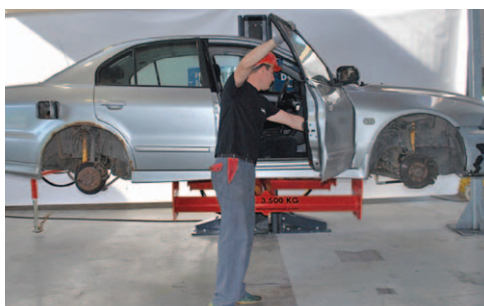
Demontáž dveří
