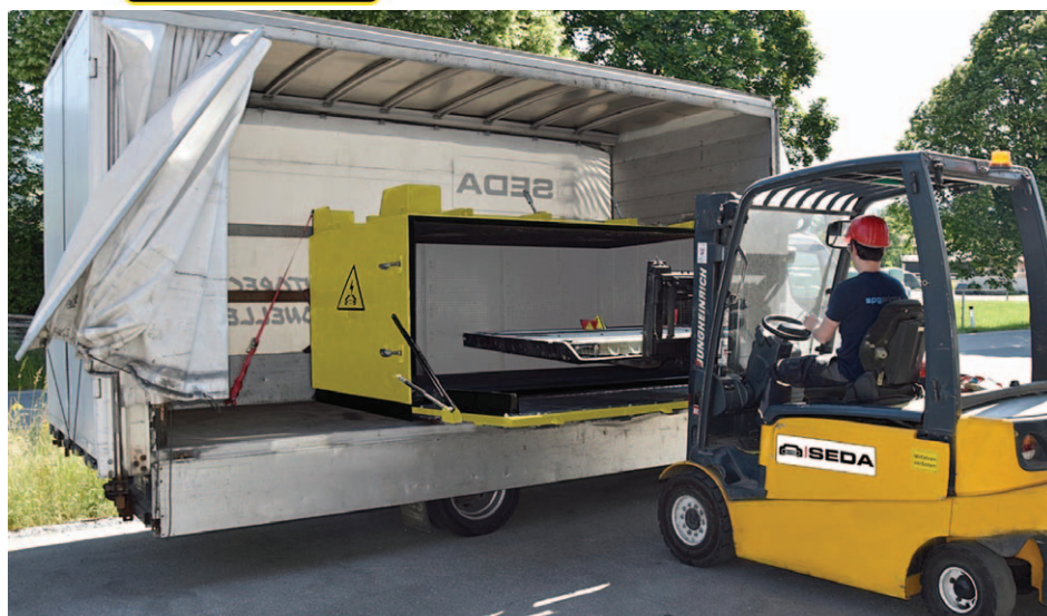
Naložení HV Bat-Box s Li-ion baterií na nákladní auto
