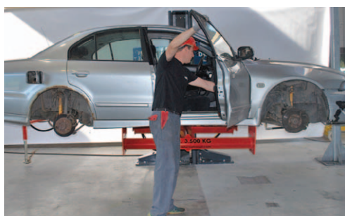
Demontáž dveří
