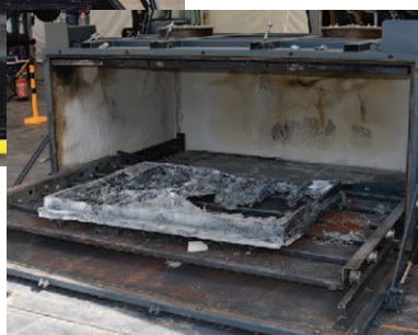
HV Bat-Box s poškozenou Li-ion baterií
