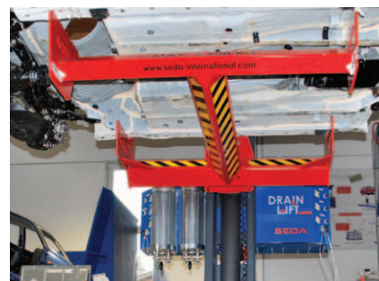
Snadný přístup ke spodní části vozidla díky tvaru H
