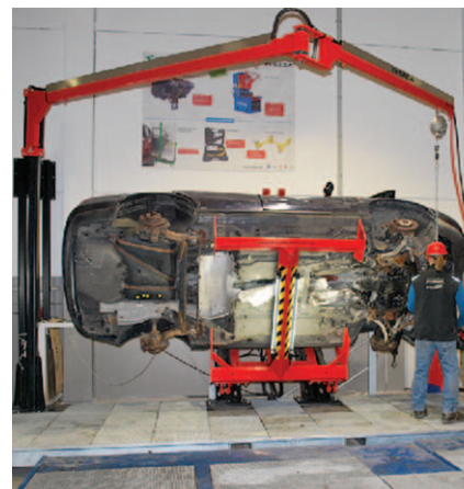
(Volitelné) kyvné rameno zkracuje čas demontáže
